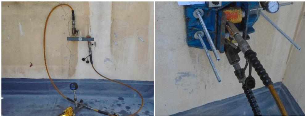
Figura 9. Ensayos de tracción y corte de anclajes
