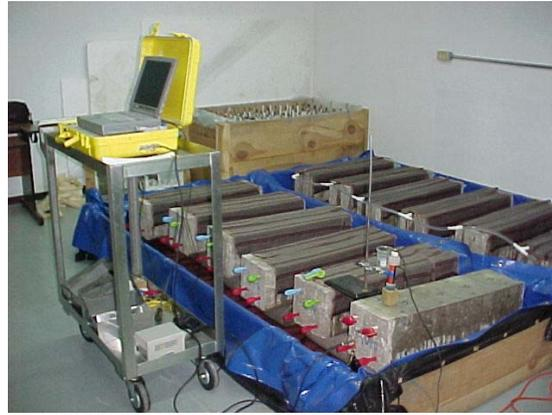
**Figura 4.** Equipo de corrosión ACM Instruments
