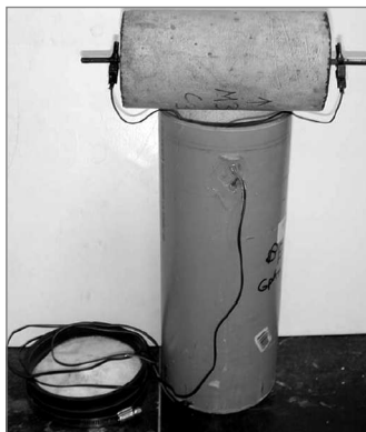
Figura 3. Ensayo de expansión con introducción de corriente eléctrica (Scott, 2006) Figure 3. Expansion test by passing electric current (Scott, 2006)
