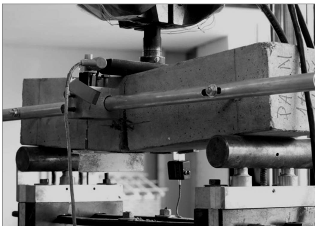
Figura 1. Ensayo de flexión de acuerdo a las recomendaciones de Gopalaratnam y Gettu (1995) Figure 1. Flexural Tet according to Gopalaratnam y Gettu (1995) recommendations
