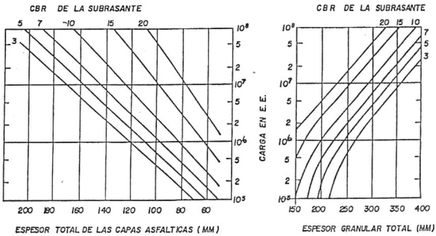
Fig. 3. Gráfico para diseño del pavimento con capas asiálticas estructurales, temperatura anual ponderada = 16° C
