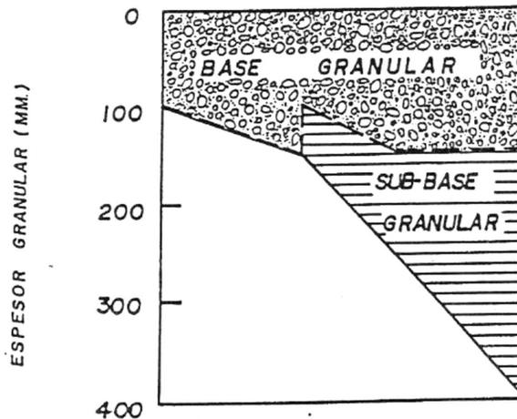
Fig. 4. Determinación de base granular, pavimento concreto asiáltico estructural
