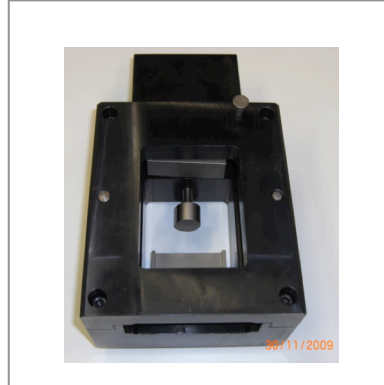
Figura 3. Equipo empleado para probar la resistencia de corte de la madera, con la Norma Brasileña Figure 3. Equipment used for testing the shear strength of wood in Brazilian Standard
