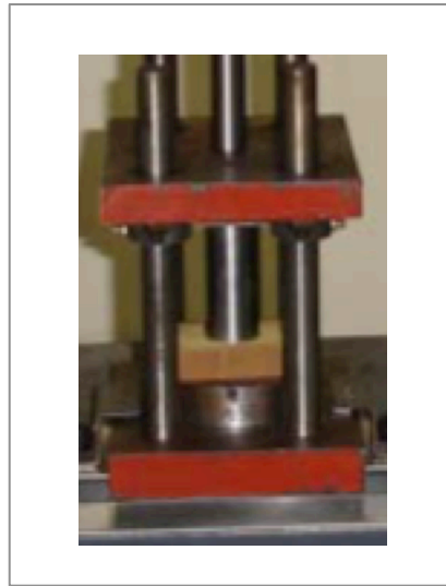
Figura 5. Arreglo de la Prueba de Punzonamiento Figure 5. Arrangement of Test for Punching
