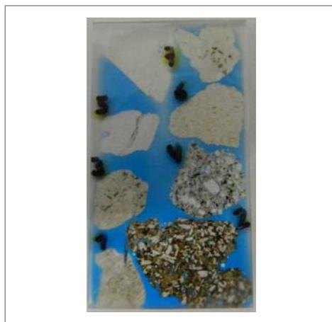
**Figura 4.** Muestra ensamblada con granos seleccionados de MGN
