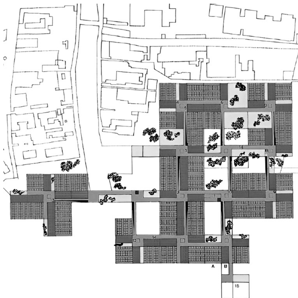
FIG. 03: Repetición del módulo en el emplazamiento. Guillermo Jullian y Le Corbusier. Fuente: María O'Byrne en "El proyecto para el Hospital de Venecia de Le Corbusier". Barcelona: 2007.
