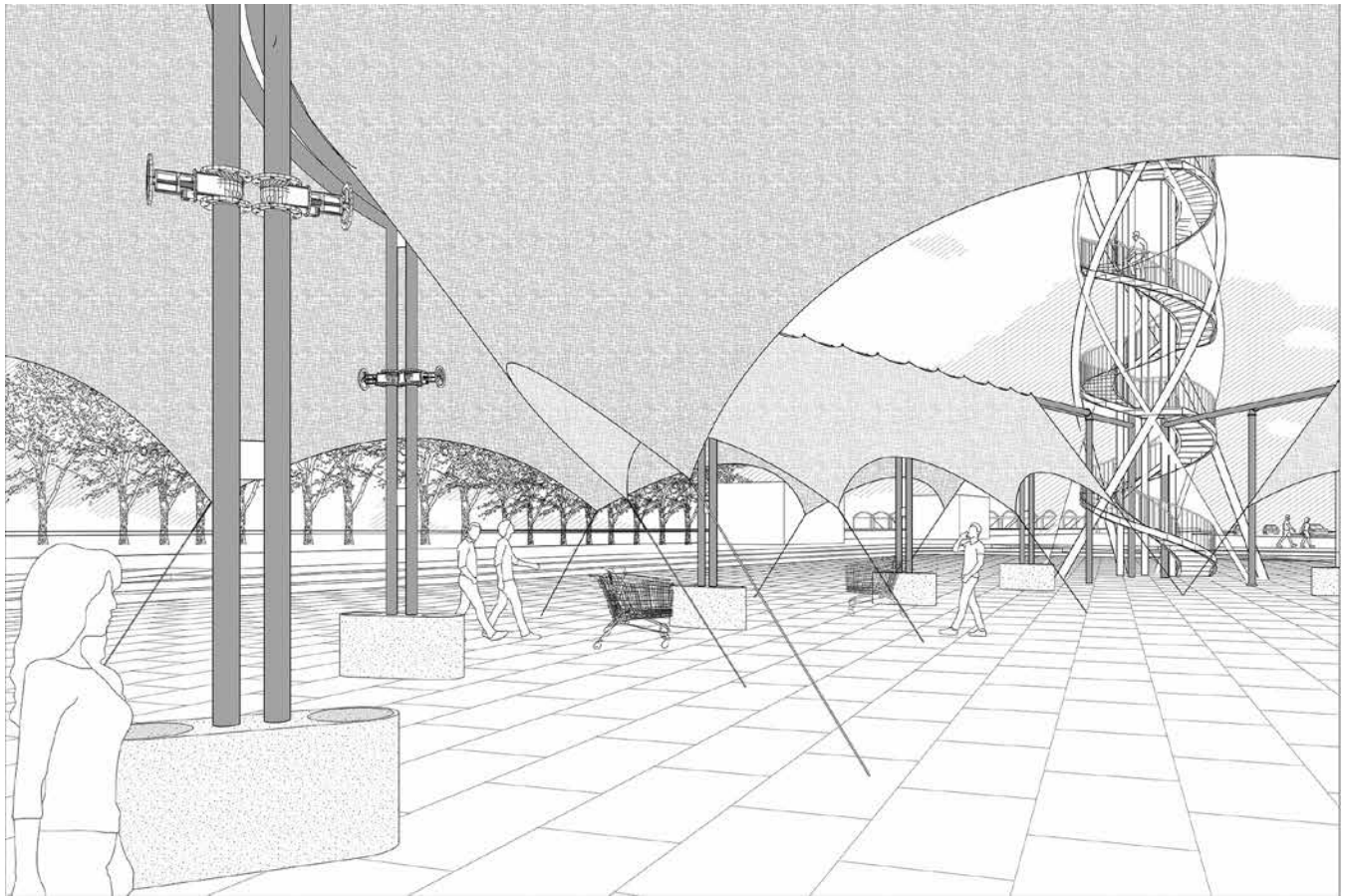
FIG. 04: Torre de agua y aceite. Capital físico. Este proyecto busca integrar la producción de comida callejera a la infraestructura urbana a través de un sistema de distribución conformado por una torre con dos estanques de agua y aceite y 22 puestos ordenados perimetralmente a una plaza. Elaboración propia.
